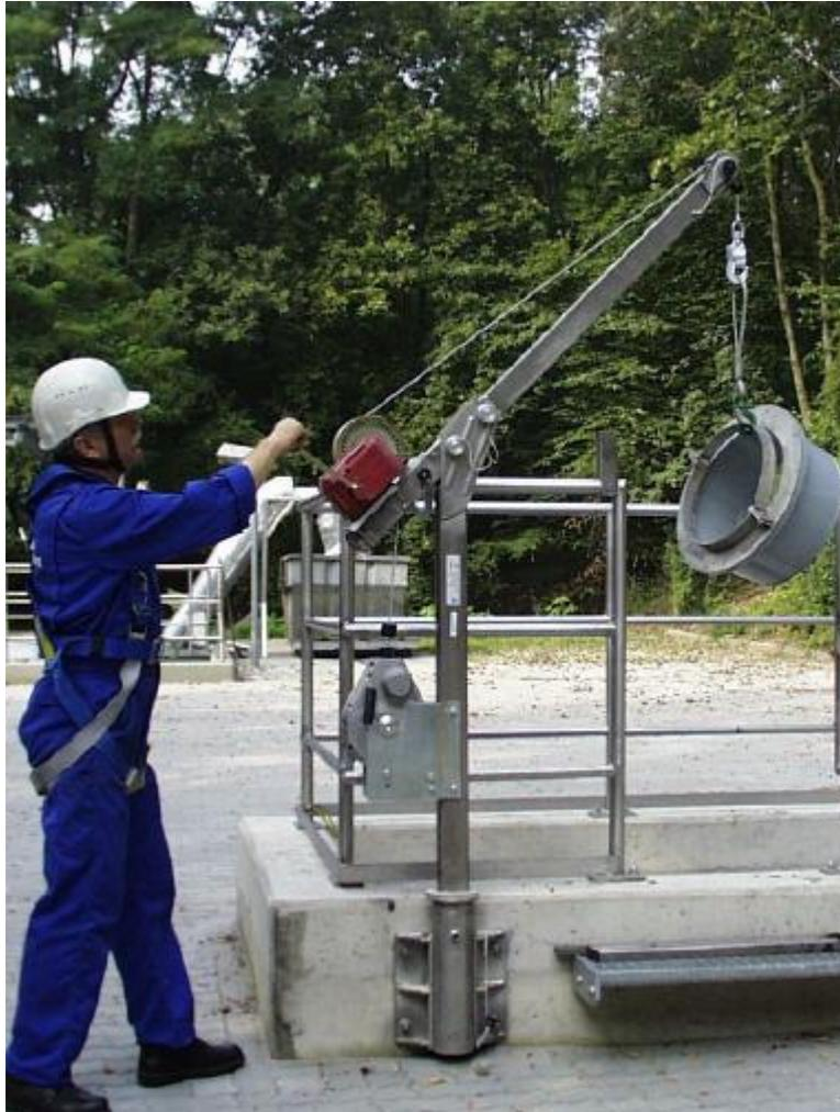
Der Auslegearm wurde speziell für den Einsatz von Höhensicherungsgeräten mit Rettungshubeinrichtung entwickelt. Er ist mit Boden- oder Wandhülsen lieferbar.
