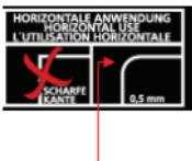
Zugelassen auch für horizontale Anwendung bei einem Kantenradius  $r = 0,5 \text{ mm}$  ohne Grat, wobei der Winkel der Kantenausführung mindestens 90° Grad betragen muss.
