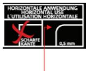
Également homologué pour l'usage horizontal avec un rayon au bord de  $r = 0,5$  mm sans bavure, l'angle formé par le bord ayant au moins 90 ° degrés.
