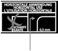
Également homologué pour l'usage horizontal avec un rayon d'arête de  $r = 0,5$  mm sans bavure, l'angle formé par l'arête devant être d'au moins  $90^\circ$  degrés. (voir également le point 3.2)
